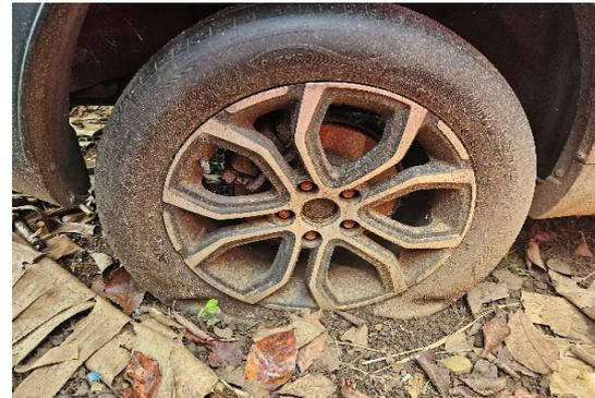
Foto 24. Detalle de llanta estallada
