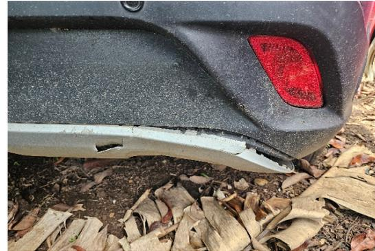
Foto 22. Detalle de daño en bumper posterior
