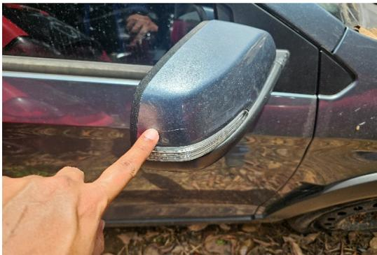
Foto 19. Detalle de daño del retrovisor
