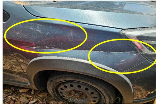
Foto 26. Detalle de daño en guardabarro
