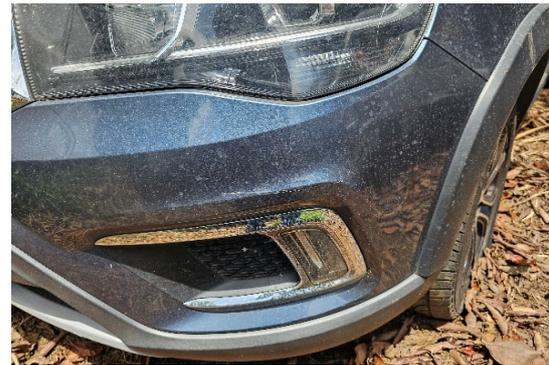
Foto 28. Detalle del daño en bumper delantero
