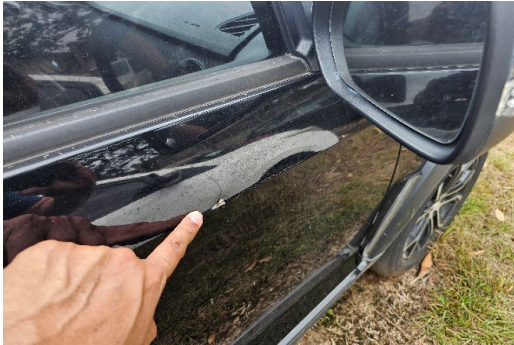
Foto 25. Detalle de daño en pintura de puerta
