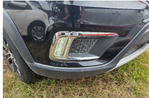
Foto 26. Detalle de daño en pintura
