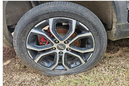
Foto 22. Detalle de llanta estallada
