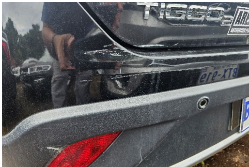
Foto 21. Detalle de daño en bumper posterior y en la pintura de la compuerta
