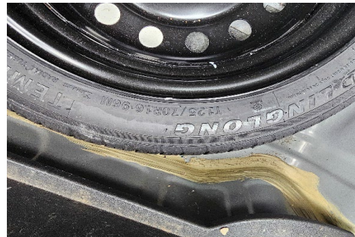
Foto 20. Detalle de daño en espacio de llanta de repuesto
