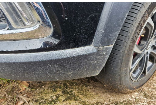
Foto 29. Detalle de daño en guardabarros
