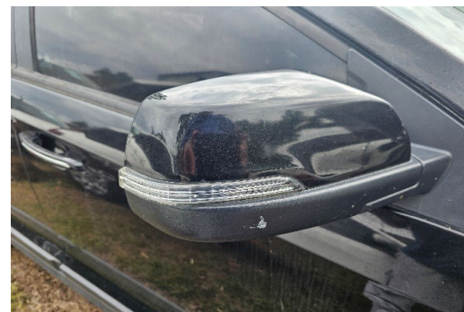
Foto 24. Detalle de daño en retrovisor
