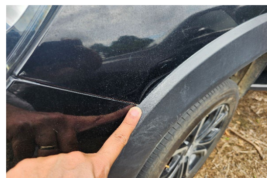
Foto 30. Daño en pintura
